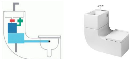
Obr. 5: Systém splachování šedou vodou – výrobek W+W firmy Roca
