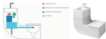
Koncept W+W od firmy Roca - splachování šedou vodou Zdroj: https://voda.tzb-info.cz; www.roca.cz
