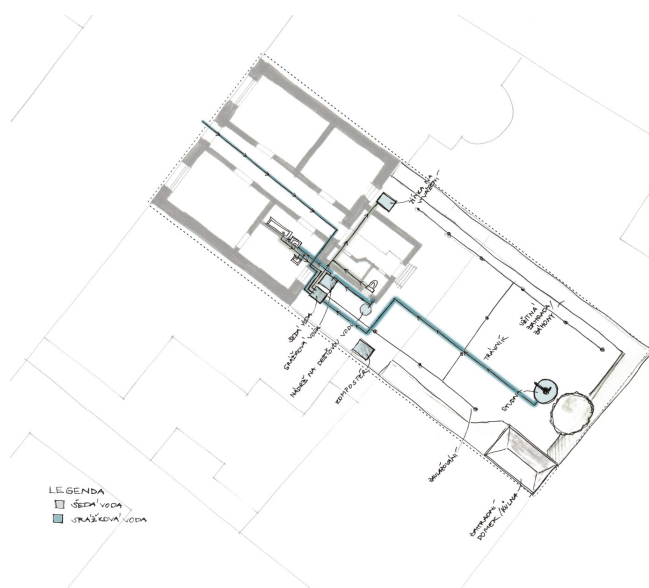
Schéma využití dešťové a odpadní vody, půdorys
