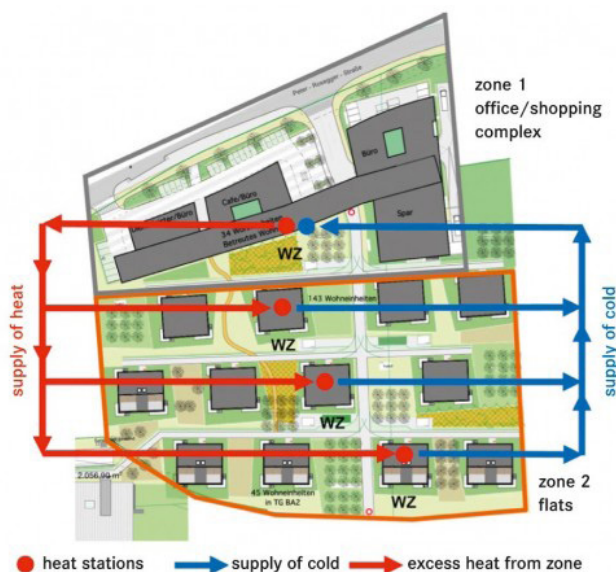
Obr. 3: Schéma koncepce dodávky tepla
